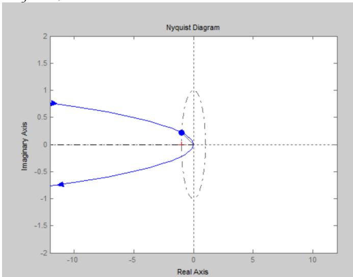
Questo diagramma necessita della chiusura ad infinito: consiste in una rotazione di pigreco in senso orario con un raggio infinito, per ogni polo con parte reale nulla.
