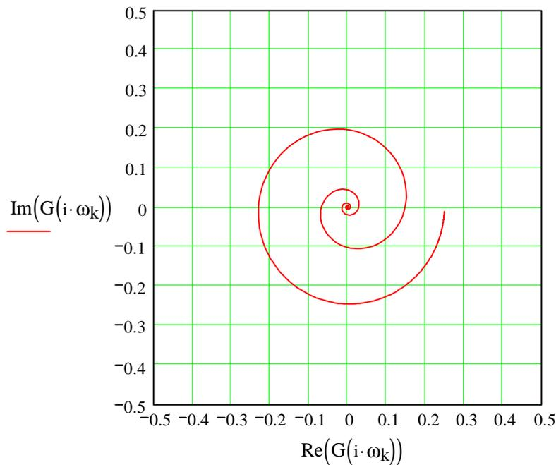
**Criterio di Nyquist:** se il diagramma di Nyquist a ciclo aperto di un sistema feedback circonda il punto (-1,0) al variare della frequenza, la risposta del sistema a ciclo chiuso è instabile.
