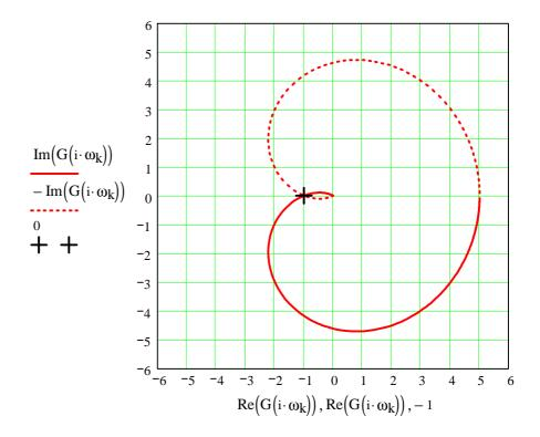
Il diagr. di Nyquist completo non consente di determinare con chiarezza i giramenti intorno a (-Proviamo ad ingrandire il diagr. di Nyquist
