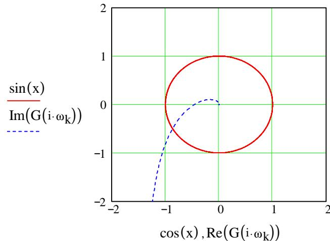
**Criterio di Nyquist:** se il diagramma di Nyquist a ciclo aperto di un sistema feedback circonda il punto  $(-1,0)$  al variare della frequenza, la risposta del sistema a ciclo chiuso è instabile.
