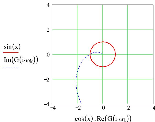
**Criterio di Nyquist:** se il diagramma di Nyquist a ciclo aperto di un sistema feedback circonda il punto (-1,0) al variare della frequenza, la risposta del sistema a ciclo chiuso è instabile.
