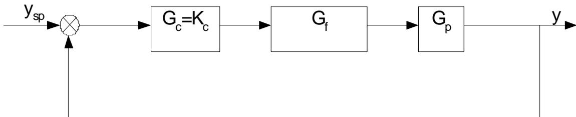
corrisponde al controllo *feedback* del processo di cui alla parte A, con un controllore proporzionale e con un elemento finale di controllo avente  $G_f = (s-2)$ .
